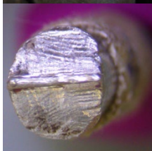
Рис. 3. Отображения следов перекуса на торцевых поверхностях объекта, образованных различными инструментами
